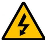
Esta señal se refiere a los sistemas eléctricos de las máquinas y los equipos, instalaciones o materiales de estos, que al entrar en contacto con las personas pueden provocar lesiones o daños personales, daños materiales e interrupción de procesos.
