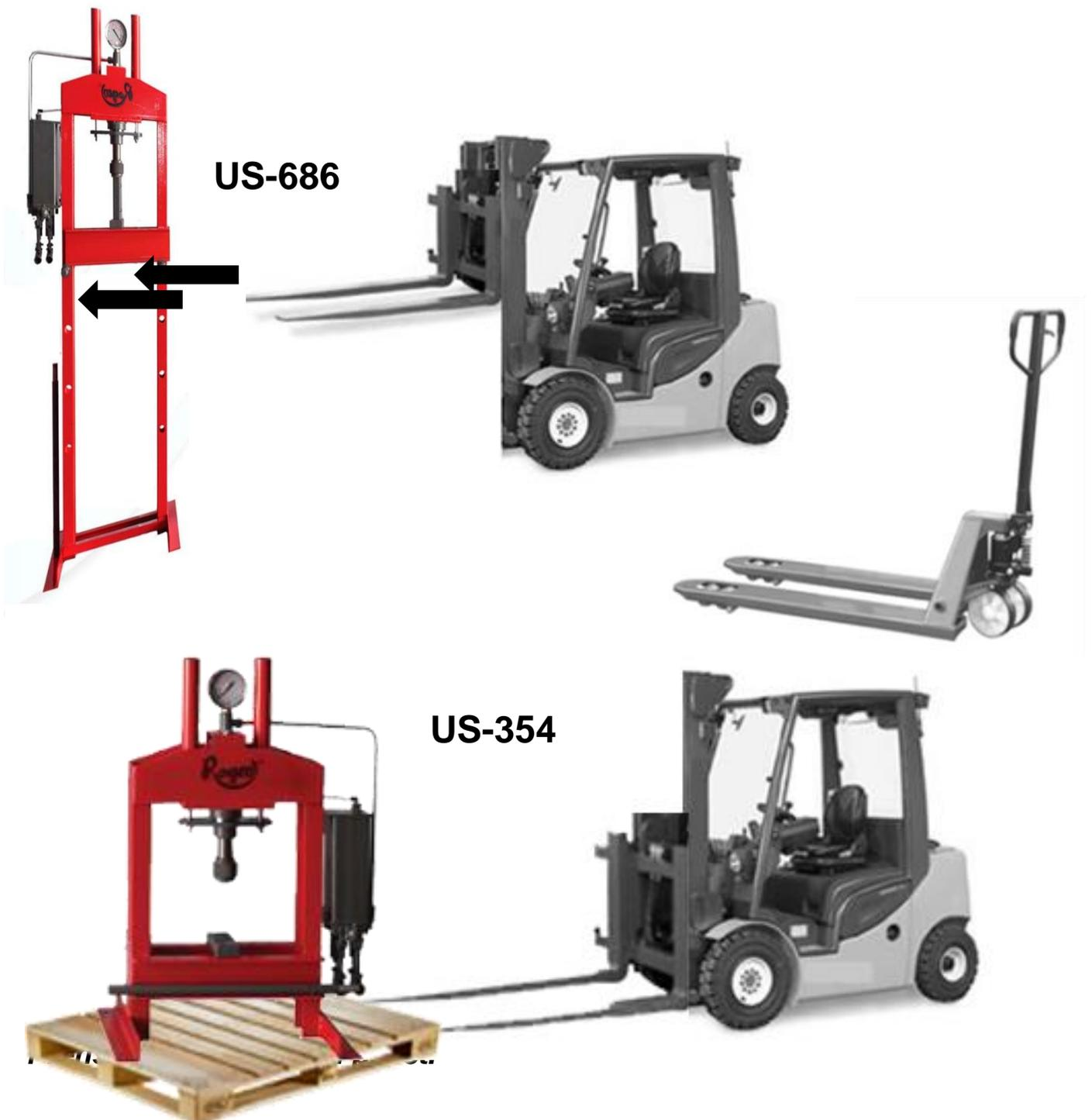
Flejar la prensa colocando dos flejes desde la base al pallet. Colocar dos flejes sobre la bancada de trabajo del polipasto hasta unir con el pallet nuevamente y finalmente, pasar un fleje desde la costilla superior de la prensa hasta unir al pallet y un segundo fleje pasando entre la costilla superior y el tubo hidráulico que une la bomba, evitar que el tubo quede flejado. **Fig. A**
