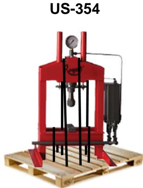
Con la carretilla elevadora ya se puede cargar el pallet y desplazar para la colocación de la prensa en su lugar correcto
