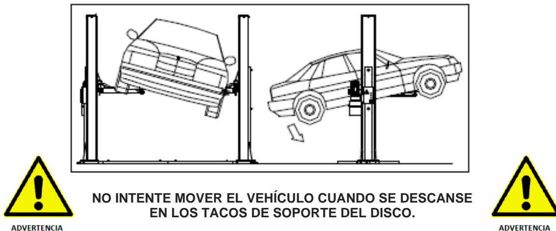
Fig.13 Riesgo de caída del vehículo
