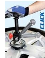
Bloqueo inteligente (Giuliano patente) es básicamente el sistema de bloqueo de rueda, manual, más rápido del mundo (Más veloz que el más veloz sistema de bloqueo neumático). Insertar el perno del SMART LOCK en el orificio central de la llanta, haciendo deslizar en el interior el mandril de bloqueo y levantar la palanca. Menos de 2 segundos para obtener el perfecto bloqueo. La tuerca de expansión interna se puede fijar fácilmente según sea necesario.
