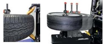
Permite el movimiento de los discos destalonadores de forma independiente, en posición desalineada con el orificio central de la llanta, garantizando así una mejor y más rápida penetración de los discos hacia el centro de la llanta durante la normal rotación a la derecha. La desalineación del disco genera un esfuerzo de torsión, que permite el destalonamiento completo e intermedio, reduciendo así el tiempo en una sola vuelta de destalonamiento.
