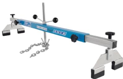
La utilización es muy fácil y simple, va equipada con la cadena y el tensor roscado. Este aparato se puede emplear en cualquier modelo de automóvil con motor delantero, debido al sistema de regulación por los prolongadores laterales y soportes de apoyo orientables. Además de servir para distintas y variadas aplicaciones es muy indicado para el desmontaje del eje delantero del motor.
