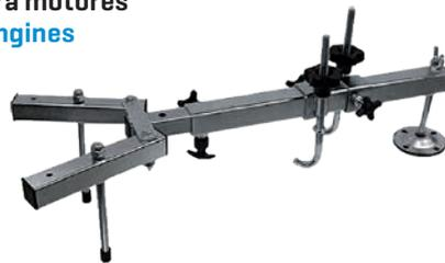
Este especial soporte permite sostener el motor cuando hay necesidad de sacar los soportes de los motores, cuando se cambia la correa de distribución, la bomba de agua, etc. Gracias a este sistema permite realizar el trabajo un sólo operario.
