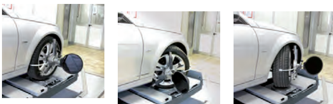
Lectura de datos en 8" Alignment reading in 8"
