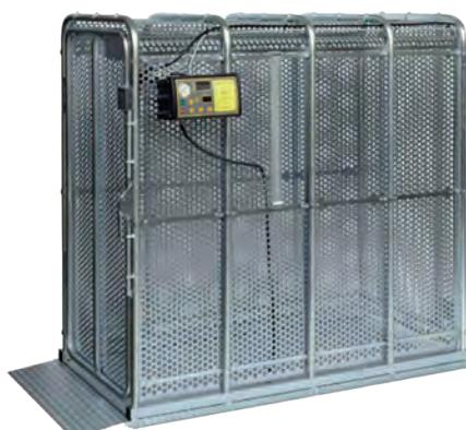
Jaula de inflado de seguridad, inflado de ruedas de turismos hasta vehículos industriales con un Ø de rueda máximo de alto 1600 mm, y de ancho hasta 800 mm. Equipada con un dispositivo de inflado electrónico digital computerizado, adaptado al inflado de casi todo tipo de neumático, hasta una presión máxima de 10 Bar (145 Psi), con una precisión excelente (0,08 Bar - 1,15 Psi). Peso, 200 Kg.
