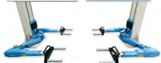
• Horquillas especiales para levantar el vehículo de las ruedas y tener los bajos completamente libres. • Indispensable en caso de retirada del paquete baterías desde abajo. • Horquillas equipadas con rodillos sobre cojinetes para permitir la rotación de la rueda.
