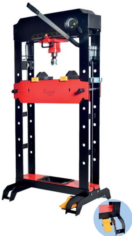
Bloques en V y diseño de guía de 180° V-blocks & 180° guiding desing
