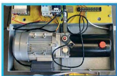
Paquete de energía Paquete de energía hidráulica estándar con 4 Alu Motor
